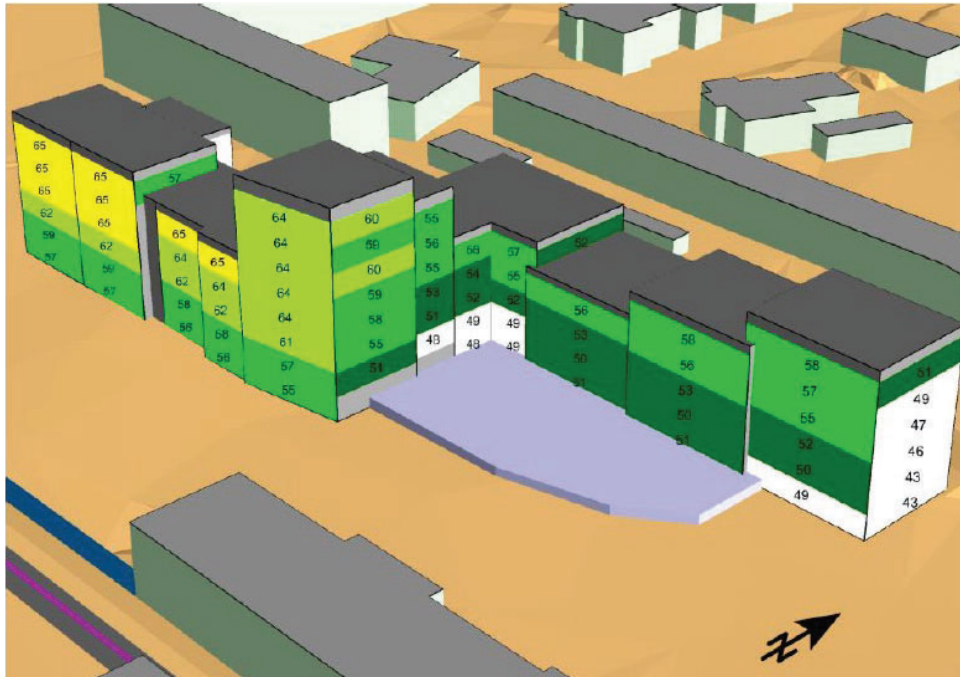
Støjbelastning fra jernbanetrafik på facader mod Banegårdspladsen. Gul farve betyder overskridelse af den vejledende grænseværdi på L_{den} 64 dB. Der optræder ikke overskridelse på de vestvendte facader.
